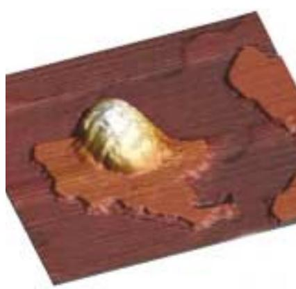
Solid lipid nanoparticle unter dem Rasterkraftmikroskop.
