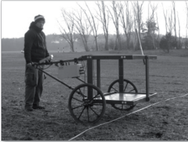
Abb. 4: Puls-Induktions-Metalldetektor EMD1 (Hersteller: Sensys) in der Seitenansicht (Foto: Ronald Freibothe)
