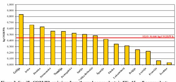
Figure 3: Specific CO2/kWh emissions from thermal power plants in EU –15 - all power plants Source: Program in predlog razdelitve emisijskih kuponov za obdobje 2008-2012, Elektroinštitut Milan Vidmar, Ljubljana: 2004
